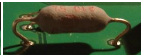
R13 - erhöht einlöten/positionieren
